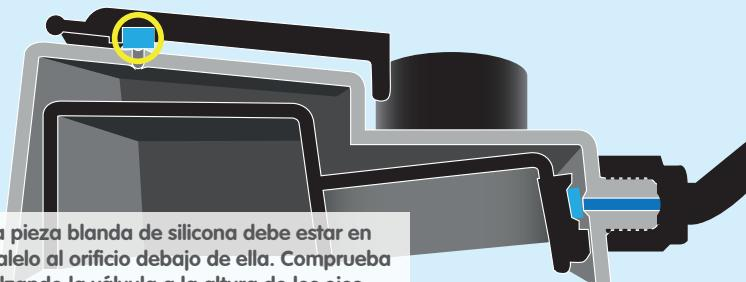
La pieza blanda de silicona debe estar en paralelo al orificio debajo de ella. Comprueba alzando la válvula a la altura de los ojos.
